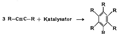
Diphenyl-acetylen trimerisierte mit einem "Katalysator" vom  $TiCl_4$ -(i-Bu)<sub>3</sub>-Al-Verhältnis 1/1 bis 1/3 zu Hexaphenyl-benzol. Dimethylacetylen lieferte beim Verhältnis 1/1,8 100 % Hexamethylbenzol, Fp 161-162 °C. Diäthyl-acetylen Hexaäthyl-benzol, Fp 127-128 °C. Der katalytische Charakter der Reaktion ergibt sich aus der Bildung von 17 Mol Cyclisierungprodukt/Mol Katalysator. (J. Amer. chem. Soc. 81, 1514 [1959]). - Ma. (Rd 706)
